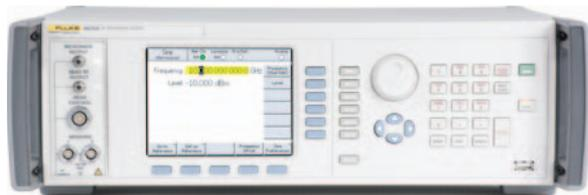
Опорный источник 96270A/LL с низкоуровневым СВЧ-выходом расширяет выходной диапазон СВЧ с  $-4$  дБм на разьеме передней панели ( $-10$  дБм на выходе сплиттера регулировочного комплекта) до  $-100$  дБм для задач, где требуются сигналы более низкого уровня на частотах до 27 ГГц. Эта возможность имеет неоценимое значение для калибровки осциллографов, а также для некоторых тестов анализаторов спектра и датчиков мощности.
