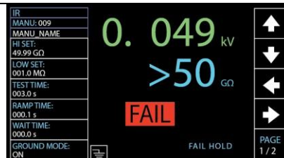
Индикатор FAIL HOLD на экране
