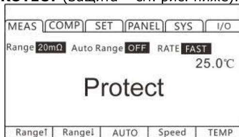
Если пользователем обнаружено на входе напряжение с превышением нормального состояния (перенапряжение), следует немедленно отключить тестовые провода от измеряемого объекта (ИУ). При срабатывании функции защиты измерения сопротивления не могут быть выполнены.
