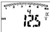
Рис.7.12 Результат на экране (12,5 В), вызванный из памяти (ячейка №4)
