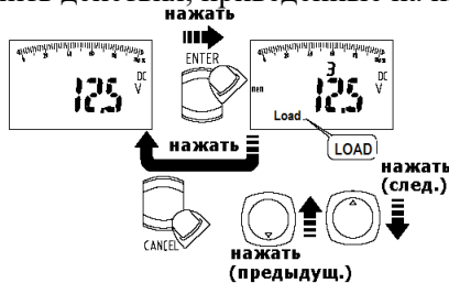
Рис.7.11 Вызов на экран результата измерений в режиме Vdc
