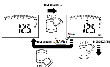
Рис.7.9 Сохранение/ Save результата измерений в режиме Vdc
