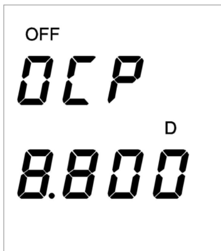
Рис.7.7 Настройка защиты от перегрузки по току
