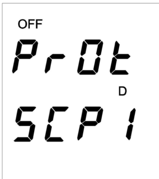
Рис.7.13 Выбор протокола передачи данных
