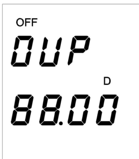
Рис.7.6 Настройка защиты от перенапряжения
