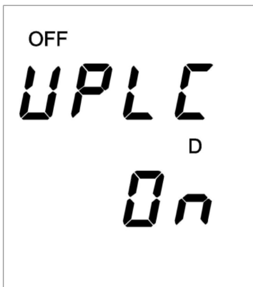
Рис.7.14 Настройка фильтра выборки напряжения
