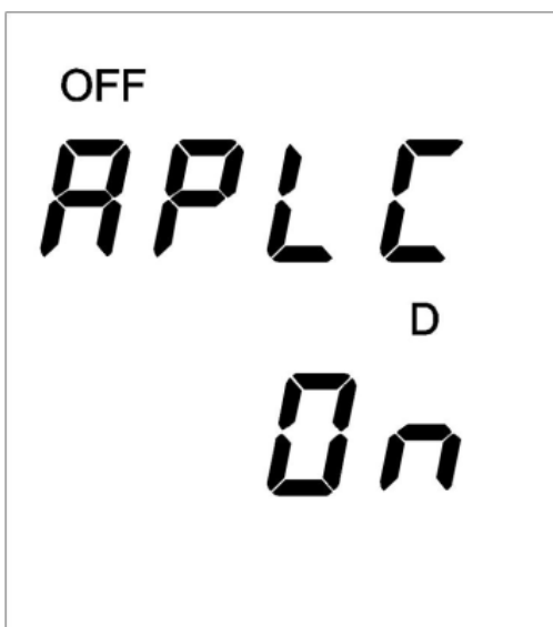
Рис.7.15 Настройка фильтра выборки силы тока
