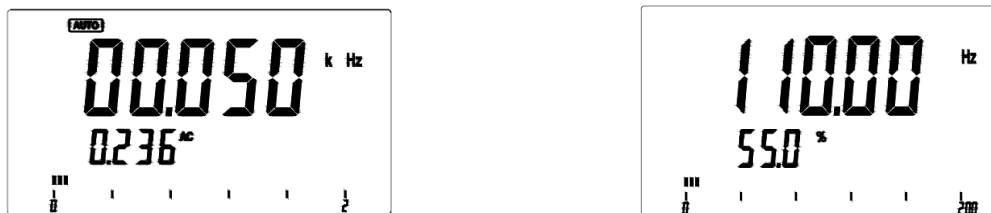
Рис. 10. Отображение ЖКИ в функции: Уров. перем. сигнала (AC) + частота (Hz) Частота (Hz) и скважность (%)
