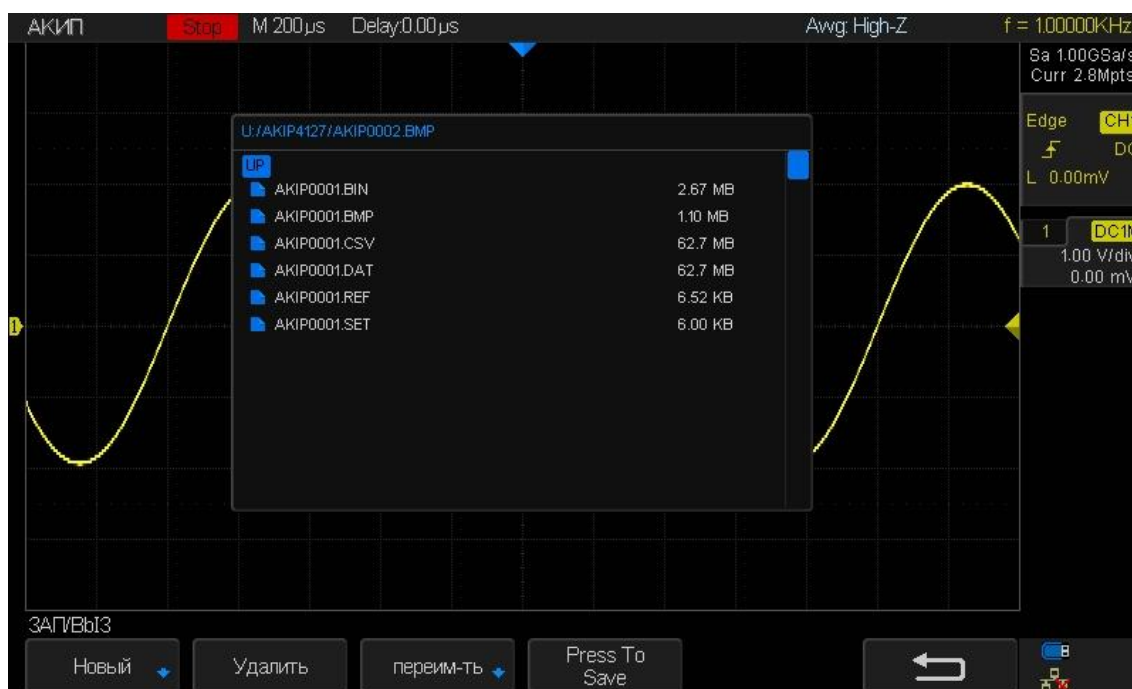
Рис. 18-1 Пример файловой системы USB диска
