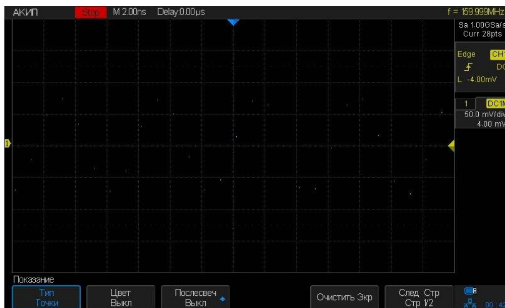
Рис. 10-1 Тип отображения сигнала – Точки
