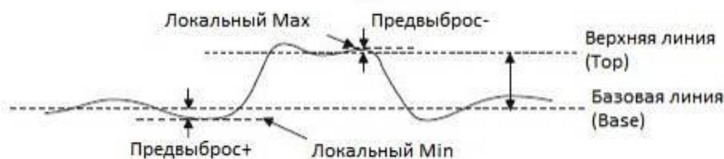
Рис. 16-3 Предвыбросы на импульсном сигнале
