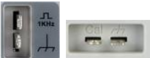
Рис. 7-2 Выход калибратора: слева (АКИП-4131/1 и АКИП-4131/2), справа (АКИП-4131/1А и АКИП-4131/2А)
