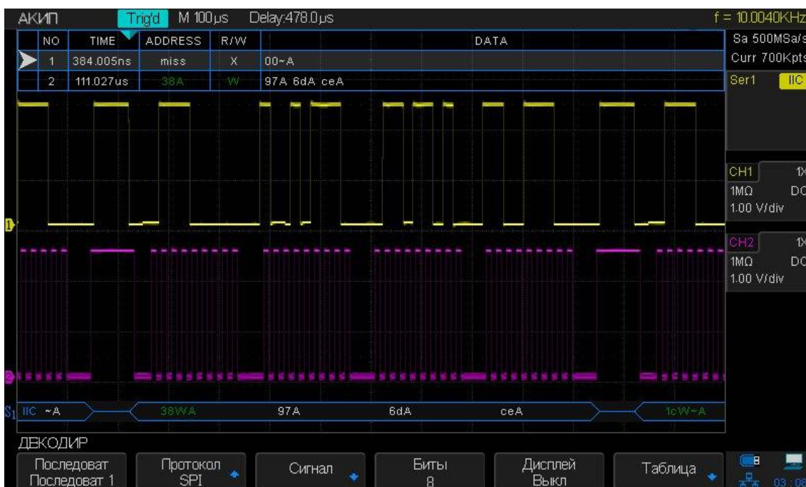
Рис. 12-4 Пример результата декодирования сигнала I2C
