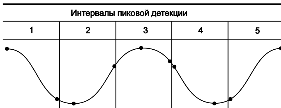
Рис. 10-5 Принцип формирования выборок пикового детектора
