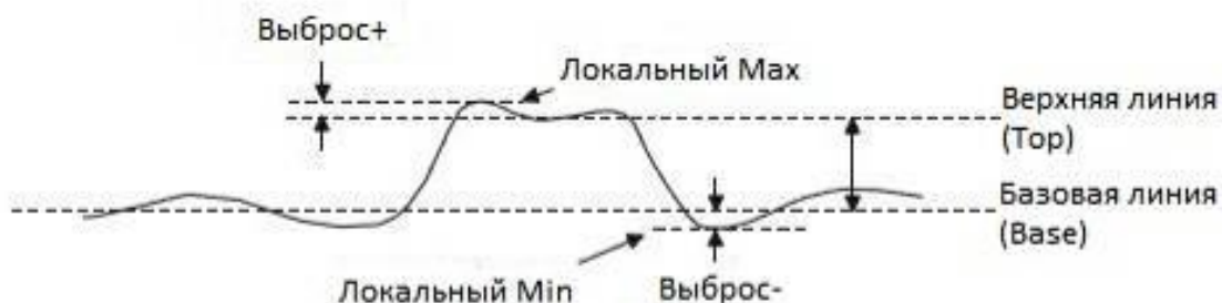
Рис. 16-2 Выбросы на импульсном сигнале
