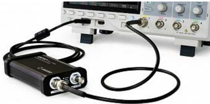
Рис. 22-1 Общий вид осциллографа с подключенным модулем генератора
