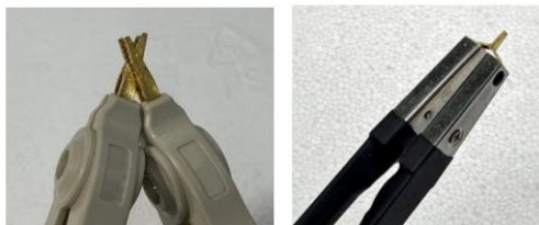
Схема/ внешний вид прибора и тестовых проводов при КЗ калибровке
