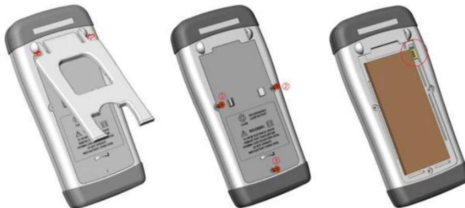
Рис. Схема установки и замены батареи питания
