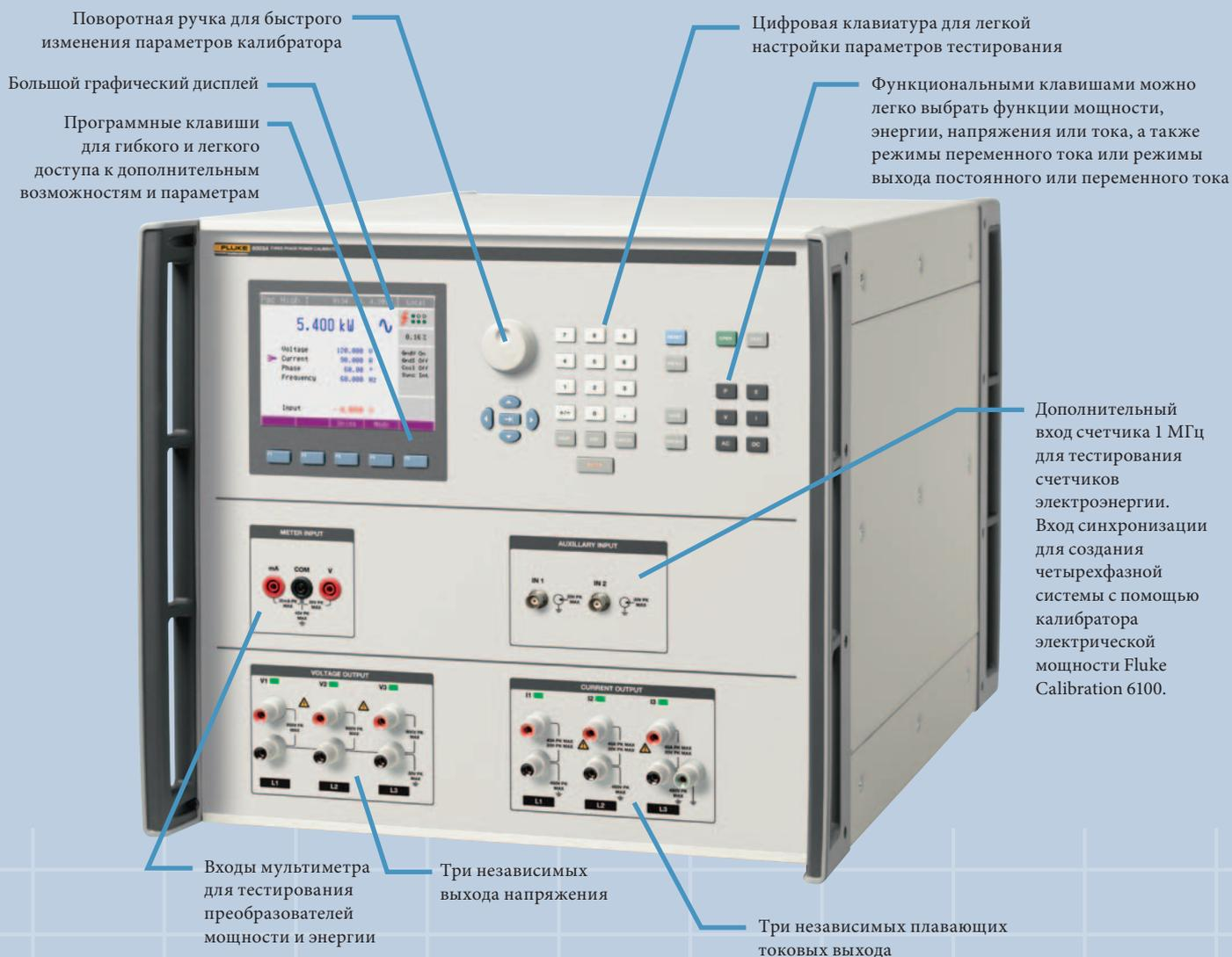
Поворотная ручка для быстрого изменения параметров калибратора
