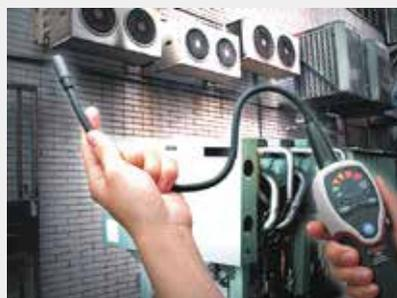
Течеискатели Center 380 и Center 382 современные микропроцессорные приборы, позволяющие надежно детектировать наличие утечек наиболее распространенных типов фреонов благодаря применению в качестве сенсора (датчика) высокочувствительного полупроводникового первичного преобразователя. Детектирование типов хладагентов Center 380: R-134a, R-404A, R-407C, R-410A, R-22; Center 382: аналогично модели 380 + дополнительно R-502, R-600A и др.
