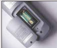
Теперь для замены элементов питания нет необходимости разбирать корпус прибора. Батарейный отсек расположен под небольшой крышечкой, удерживаемой всего одним винтом.
