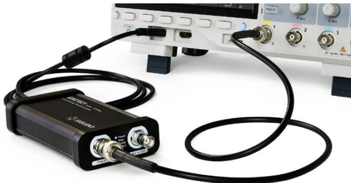
**Внешний модуль функционального генератора (SAG1021).**
