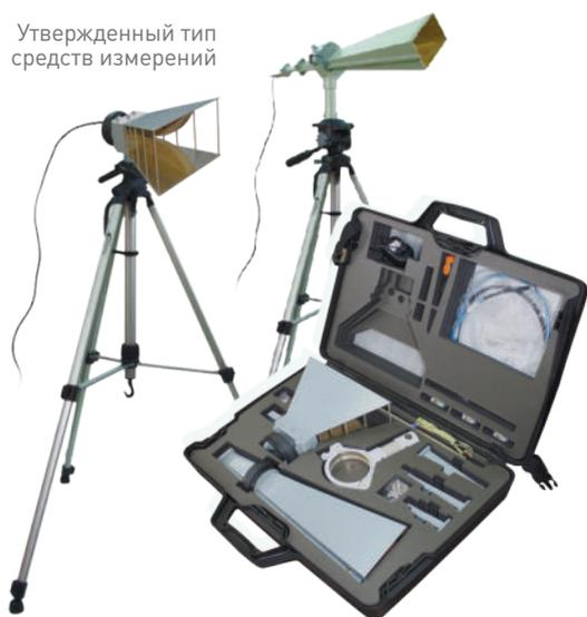
АИК 1-40Б - комплект метрологически согласованных средств измерений и вспомогательных устройств, позволяющий обеспечить все необходимые варианты построения измерительного тракта, начиная с измерительной антенны и до входа анализатора спектра, измерительного приемника или иного приемного измерительного устройства.
