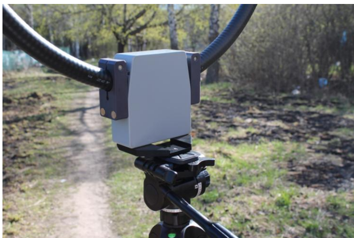
Фото 3. Вариант крепления антенны П6-119 на фотоштатив
