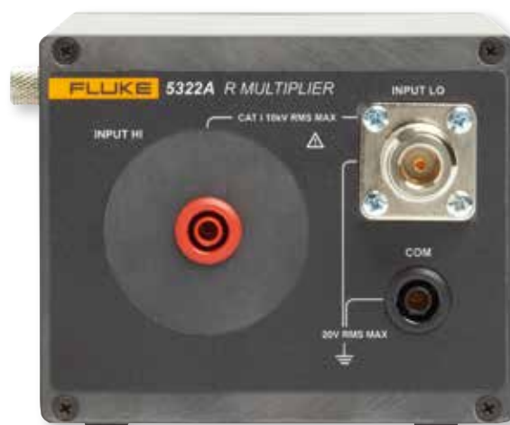
Каждый прибор 5322A поставляется с внешним умножителем сопротивления, который обеспечивает сопротивление до 10 ТОм для проверки тестеров сопротивления изоляции.
