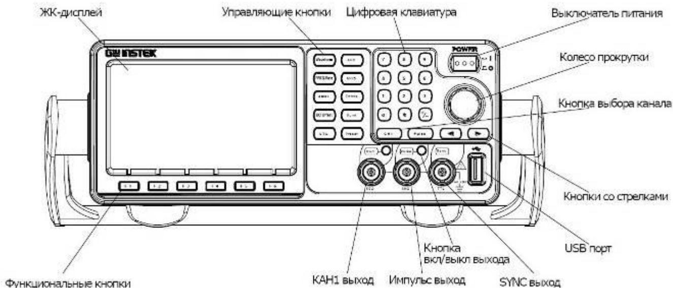
Рис. 4.3 Передняя панель MFG-72120MA/72130M
