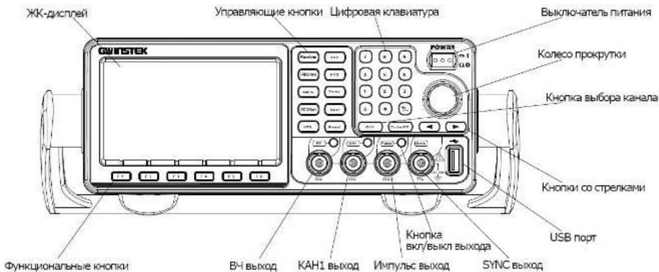
Рис. 4.2 Передняя панель MFG-72160MR/72160MF
