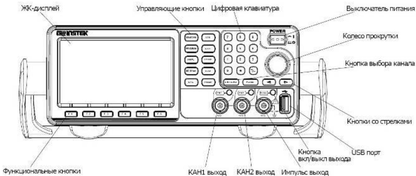
Рис. 4.5 Передняя панель MFG-72260M/72230M
