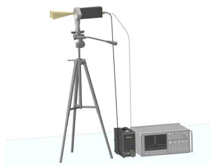
Рис. 4 Антенна П6-132 с преобразователем частоты СК5РТ 26-40/3-18 WR28
