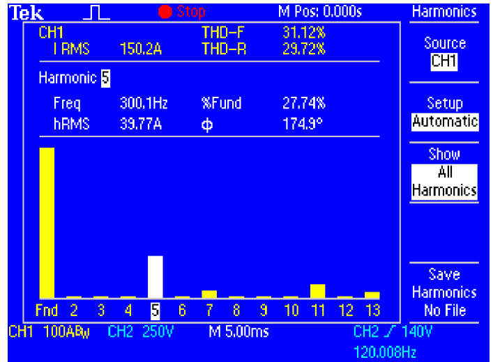
Измерение гармонических искажений с помощью ПО TPS2PWR1.
