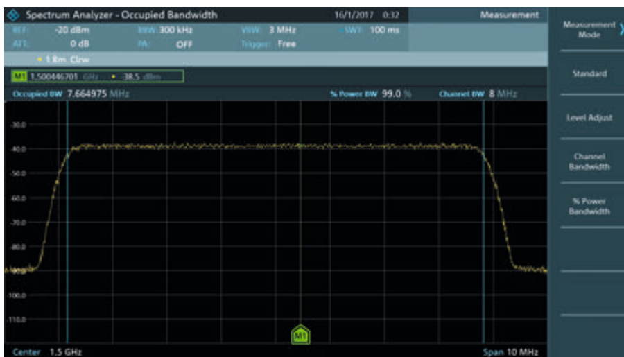
Опция R&S®FPC-K55: занимаемая полоса частот.
