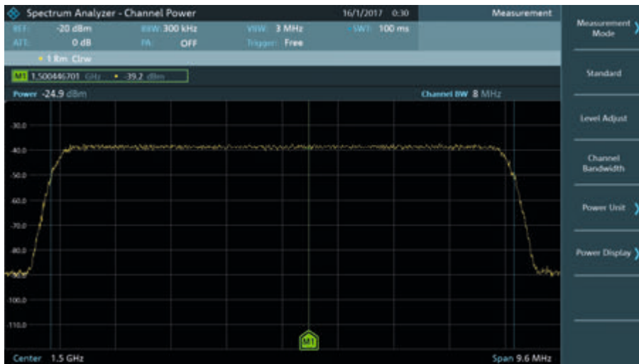
Опция R&S®FPC-K55: мощность в канале.
