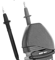
Рис. 3: Использование защитного наконечника для крепления испытательных щупов
