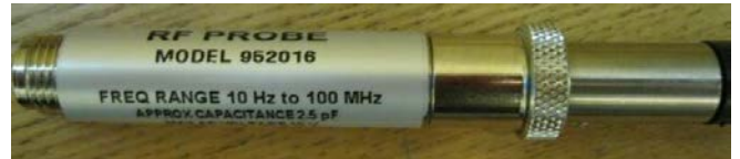
Измерительный зонд 95201603B (диапазон частот от 10 Гц до 100 МГц)
